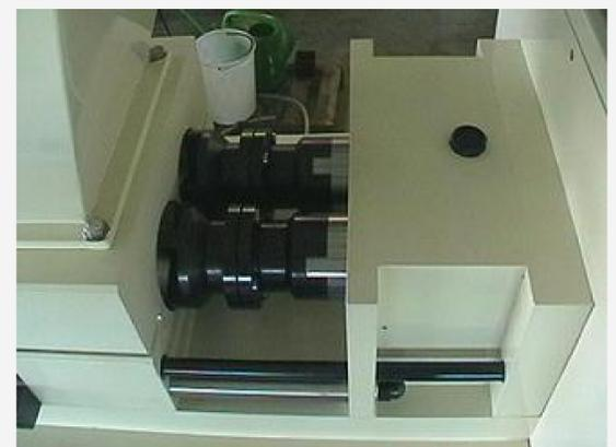
Figure 2: Antriebseinheit mit Überlastkupplungen
